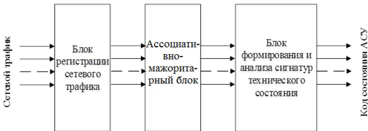
Рисунок 7 – Технологическая схема процесса преобразования информации о сетевых потоках в системе мониторинга сетевого трафика
