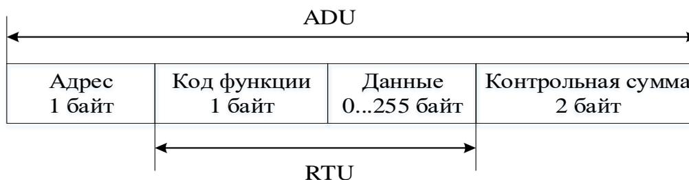
Рисунок В.1 – Формат кадра протокола Modbus RTU
